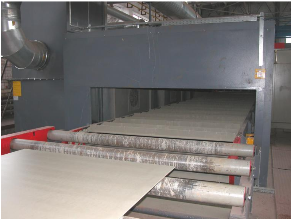
Фото 8. Выходной рольганг. Внешний вид огрунтованного стального листа. Равномерное покрытие без пропусков и потеков.
