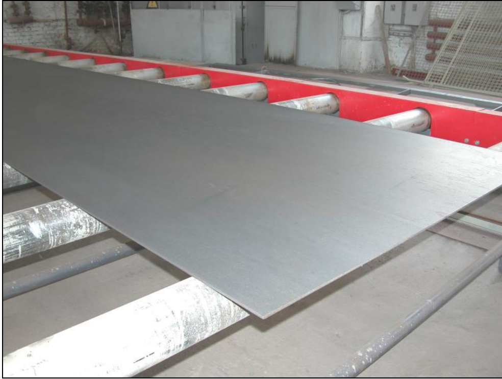
Фото 7. Внешний вид поверхности стального листа после сухой струйной абразивной очистки. Прокатная окалина и ржавчина отсутствуют.
