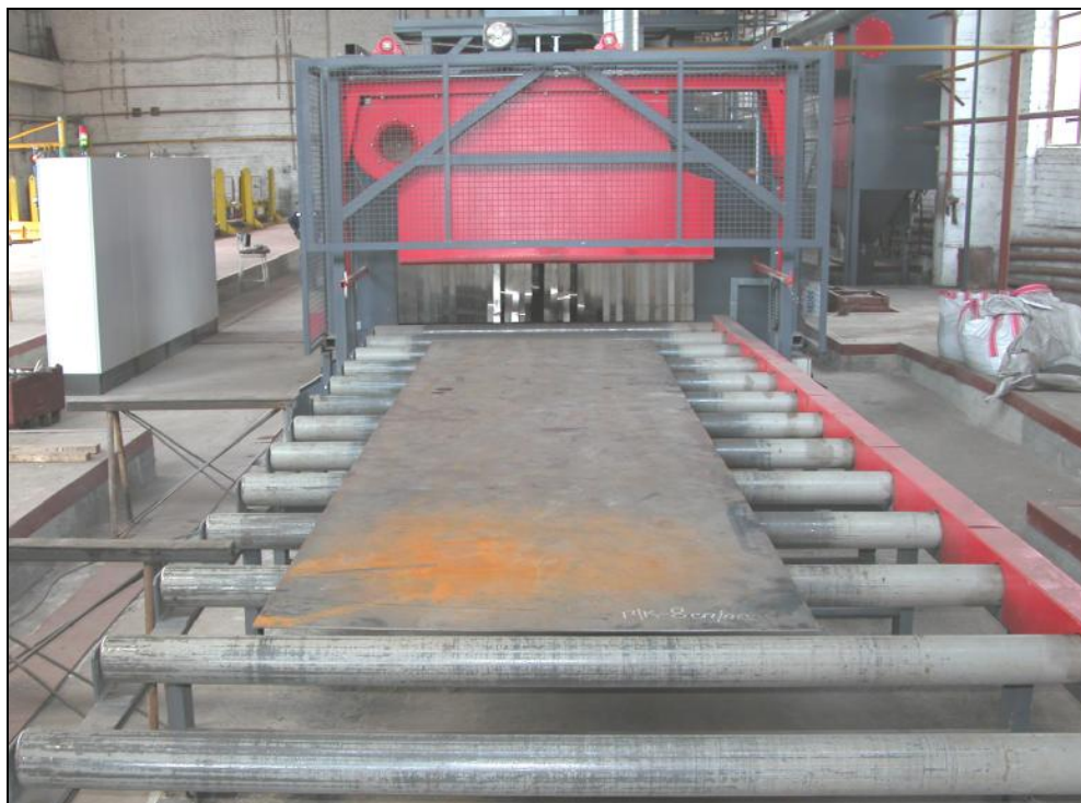
Фото 1. Внешний вид линии со стороны входного рольганга. На рольганге стальной лист с прокатной окалиной и ржавчиной.
