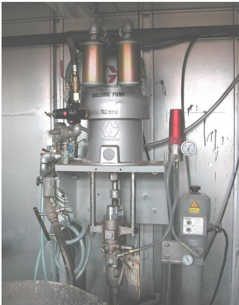
Фото 4. Окрасочный агрегат высокого давления «Buldog» фирмы «Graco», используемый для нанесения грунтовочного покрытия.
