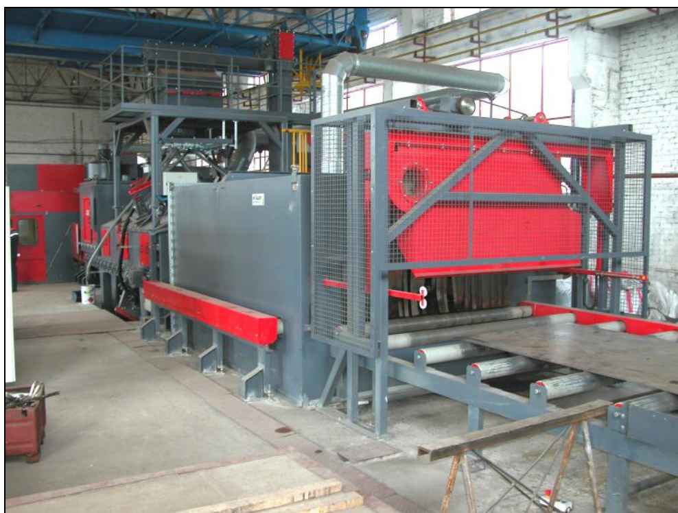
Фото 2. Камера обогрева с принудительной вентиляцией, за ней видна дробеметная камера.
