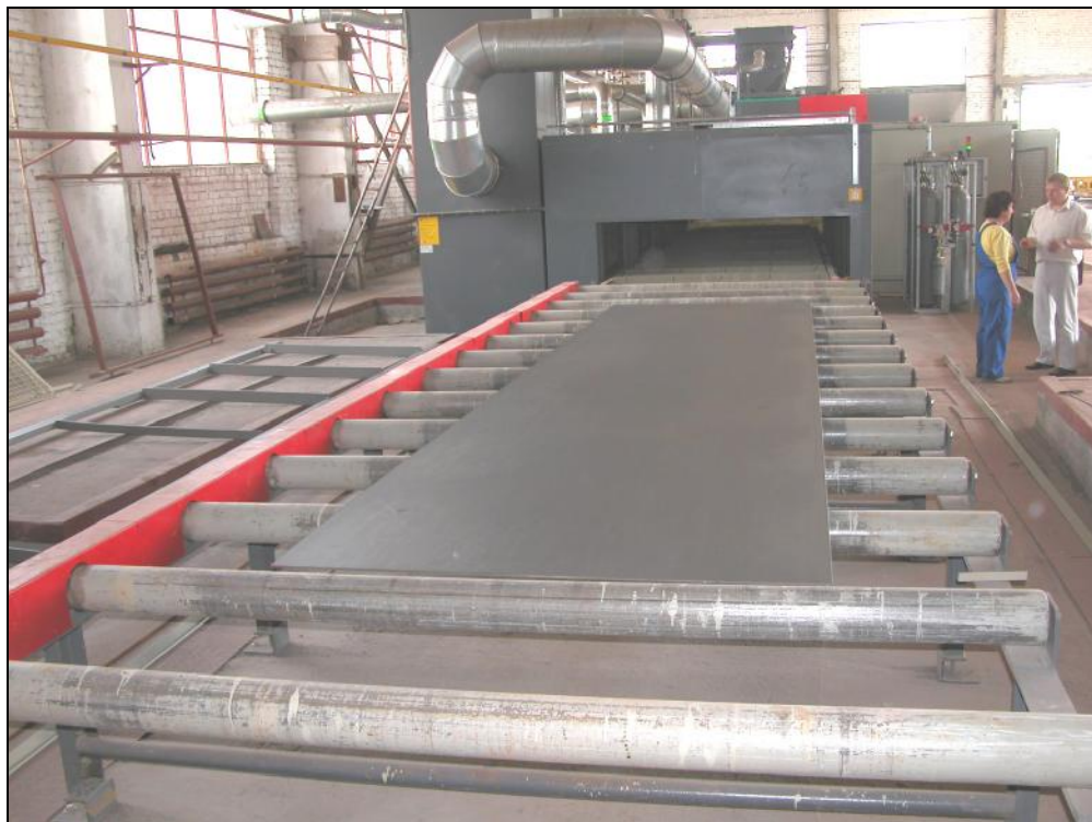
Фото 6. Внешний вид линии со стороны выходного рольганга. На рольганге стальной лист, очищенный от прокатной окалины и ржавчины.
